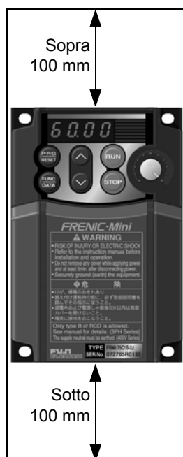
Figura 2-2-1 Sistemazione e distanze necessarie
