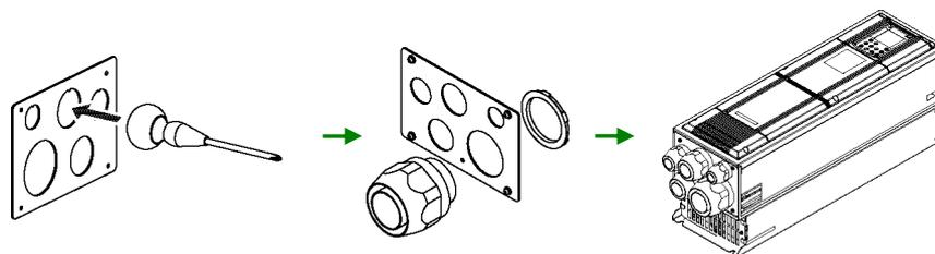
Figure 2.3 Poinçonnement des sections semi-perforées dans la plaque de câblage et montage des presse-étoupes ou des conduites
