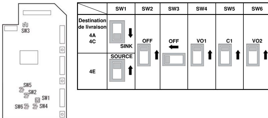
Figure 2.4 Position des commutateurs sur le PCB de commande
