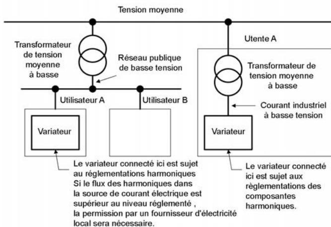
Figure 8.3 Bloc d'alimentation et réglementation
